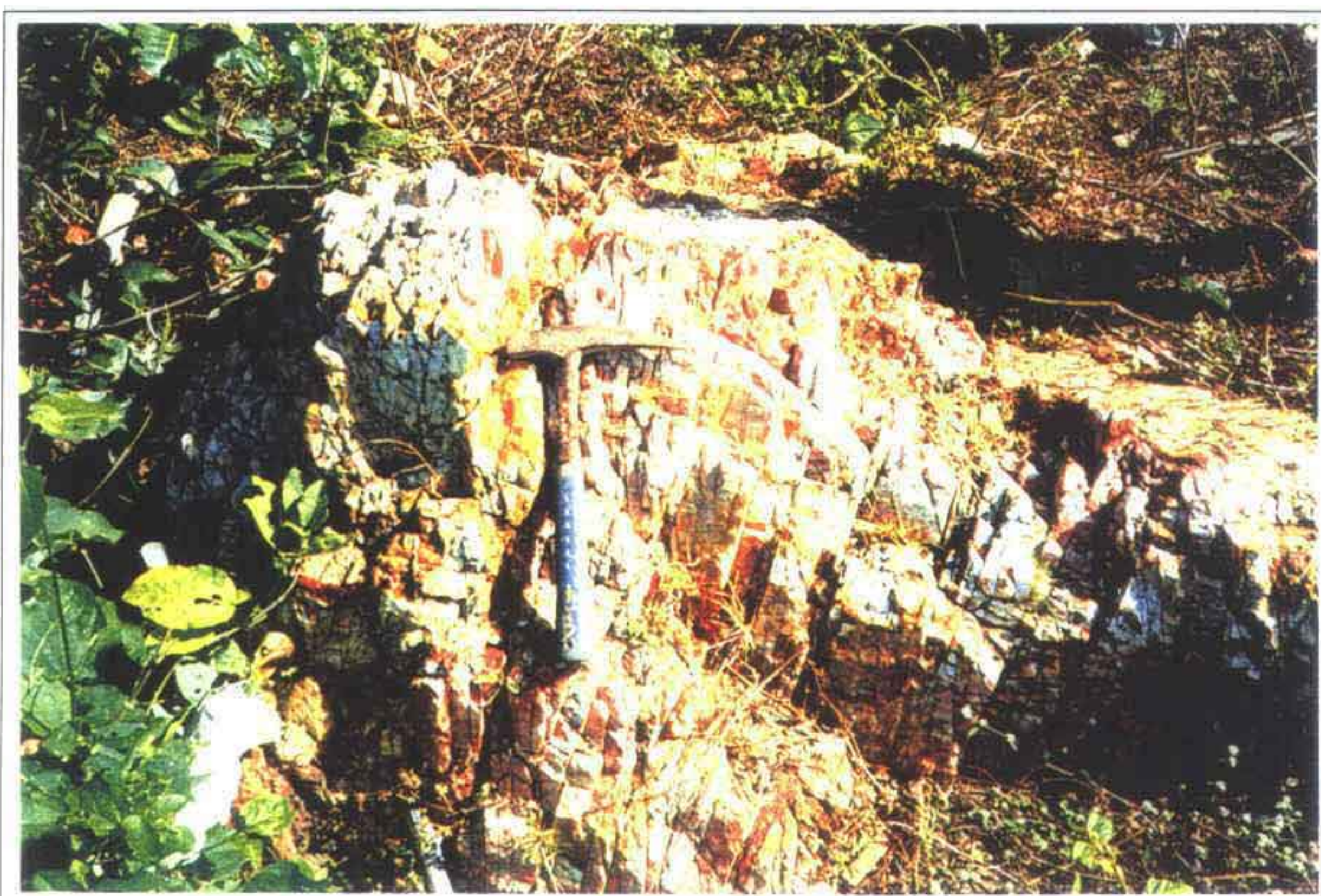
FOTO 06/17 - Aspectos do quartzito, onde observa-se um elevado grau de fraturamento (Eixo do Barramento - Coordenadas UTM 258.817/9.651.213).
